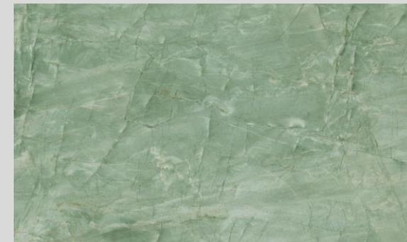
O quartzito natural Emerald Green apresenta um grau de absorção médio sendo necessário impermeabilizar todo o material (hidro óleo repelente na superfície e nos topos e argamassa polimérica impermeabilizante no verso, respeitando o tempo de cura dos produtos aplicados e aguardando secagem completa da argamassa para o rejuntamento). Suporta variação de temperatura e não apresenta problemas com produtos pouco ácidos e alcalinos.
