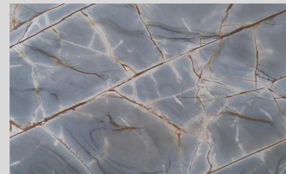
O traquito Blue Roma apresenta um grau de absorção médio sendo necessário impermeabilizar todo o material (hidro óleo repelente na superfície e nos topos e argamassa polimérica impermeabilizante no verso, respeitando o tempo de cura dos produtos aplicados e aguardando secagem completa da argamassa para o rejuntamento). Suporta variação de temperatura e não apresenta problemas com produtos pouco ácidos e alcalinos.
