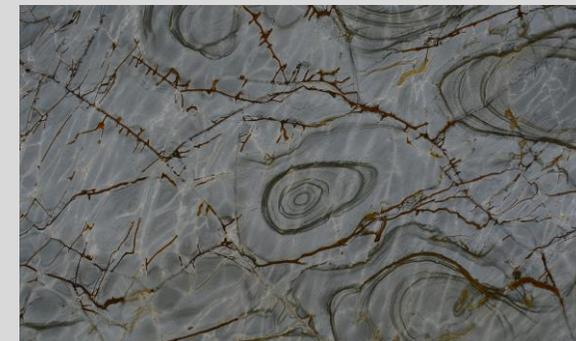
O traquito Blue Deep apresenta um grau de absorção médio sendo necessário impermeabilizar todo o material (hidro óleo repelente na superfície e nos topos e argamassa polimérica impermeabilizante no verso, respeitando o tempo de cura dos produtos aplicados e aguardando secagem completa da argamassa para o rejuntamento). Suporta variação de temperatura e não apresenta problemas com produtos pouco ácidos e alcalinos.
