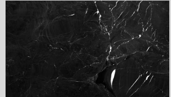
O mármore dolomítico Nero apresenta um grau de absorção considerável sendo necessário impermeabilizar todo o material (hidro óleo repelente na superfície e nos topos e argamassa polimérica impermeabilizante no verso, respeitando o tempo de cura dos produtos aplicados e aguardando secagem completa da argamassa para o rejuntamento). Ter cuidado com variação de temperatura e produtos ácidos e alcalinos.
