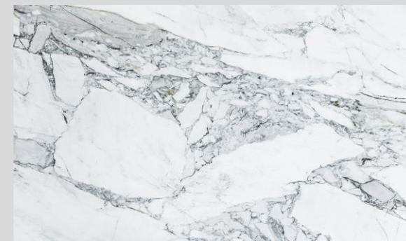
O mármore Calacatta Prime apresenta um grau de absorção considerável sendo necessário impermeabilizar todo o material com hidro óleo repelente na superfície e nos topos e argamassa polimérica impermeabilizante no verso, respeitando o tempo de cura dos produtos aplicados e aguardando secagem completa da argamassa para o rejuntamento. Ter cuidado com variação de temperatura e produtos ácidos e alcalinos.
