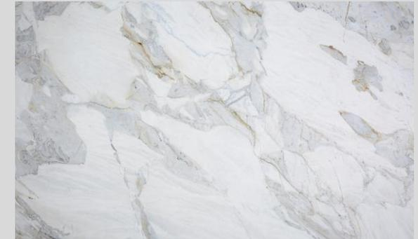
O mármore Matarazzo apresenta um grau de absorção considerável sendo necessário impermeabilizar todo o material (hidro óleo repelente na superfície e nos topos e argamassa polimérica impermeabilizante no verso, respeitando o tempo de cura dos produtos aplicados e aguardando secagem completa da argamassa para o rejuntamento). Ter cuidado com variação de temperatura e produtos ácidos e alcalinos.
