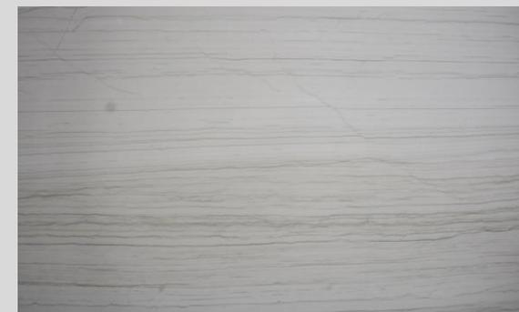
O quartzito Casablanca apresenta um grau de absorção médio sendo necessário impermeabilizar todo o material (hidro óleo repelente na superfície e nos topos e argamassa polimérica impermeabilizante no verso, respeitando o tempo de cura dos produtos aplicados e aguardando secagem completa da argamassa para o rejuntamento). Suporta variação de temperatura e não apresenta problemas com produtos pouco ácidos e alcalinos.
