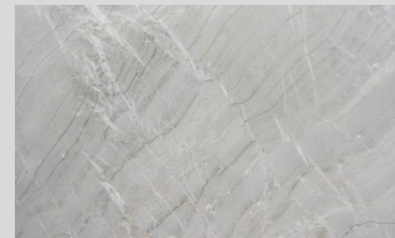
O quartzito natural Gabana apresenta um grau de absorção médio sendo necessário impermeabilizar todo o material (hidro óleo repelente na superfície e nos topos e argamassa polimérica impermeabilizante no verso, respeitando o tempo de cura dos produtos aplicados e aguardando secagem completa da argamassa para o rejuntamento). Suporta variação de temperatura e não apresenta problemas com produtos pouco ácidos e alcalinos.
