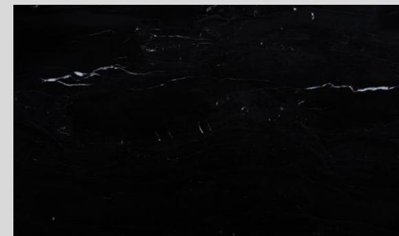
O mármore Phantom Black apresenta um grau de absorção considerável sendo necessário impermeabilizar todo o material (hidro óleo repelente na superfície e nos topos e argamassa polimérica impermeabilizante no verso, respeitando o tempo de cura dos produtos aplicados e aguardando secagem completa da argamassa para o rejuntamento). Ter cuidado com variação de temperatura e produtos ácidos e alcalinos.
