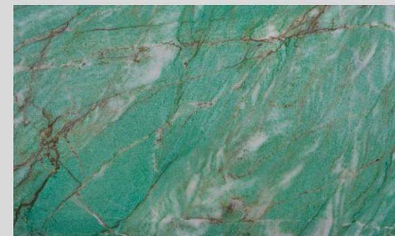
O quartzito natural Verde Gaya apresenta um grau de absorção médio sendo necessário impermeabilizar todo o material (hidro óleo repelente na superfície e nos topos e argamassa polimérica impermeabilizante no verso, respeitando o tempo de cura dos produtos aplicados e aguardando secagem completa da argamassa para o rejuntamento). Suporta variação de temperatura e não apresenta problemas com produtos pouco ácidos e alcalinos.
