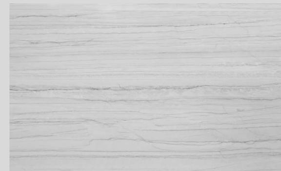
O quartzito White Macaubas apresenta um grau de absorção médio sendo necessário impermeabilizar todo o material (hidro óleo repelente na superfície e nos topos e argamassa polimérica impermeabilizante no verso, respeitando o tempo de cura dos produtos aplicados e aguardando secagem completa da argamassa para o rejuntamento). Suporta variação de temperatura e não apresenta problemas com produtos pouco ácidos e alcalinos.
