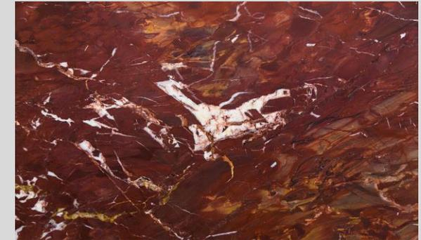
O mármore dolomítico Napoleon Bordeaux apresenta um grau de absorção considerável sendo necessário impermeabilizar todo o material com hidro óleo repelente na superfície e nos topos e argamassa polimérica impermeabilizante no verso, respeitando o tempo de cura dos produtos aplicados e aguardando secagem completa da argamassa para o rejuntamento. Ter cuidado com variação de temperatura e produtos ácidos e alcalinos.
