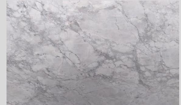
O mármore Arabescato apresenta um grau de absorção considerável sendo necessário impermeabilizar todo o material (hidro óleo repelente na superfície e nos topos e argamassa polimérica impermeabilizante no verso, respeitando o tempo de cura dos produtos aplicados e aguardando secagem completa da argamassa para o rejuntamento). Ter cuidado com variação de temperatura e produtos ácidos e alcalinos.
