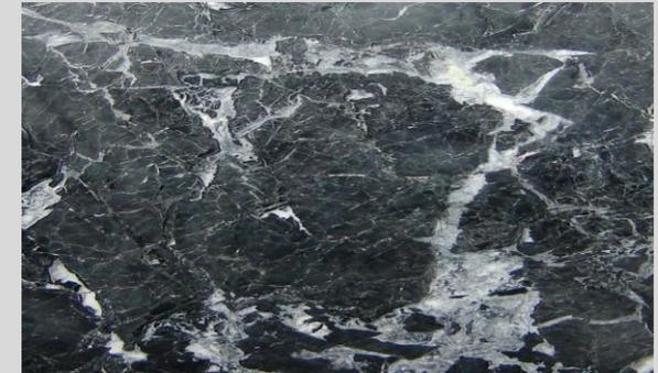
O mármore dolomítico Grigio apresenta um grau de absorção considerável sendo necessário impermeabilizar todo o material (hidro óleo repelente na superfície e nos topos e argamassa polimérica impermeabilizante no verso, respeitando o tempo de cura dos produtos aplicados e aguardando secagem completa da argamassa para o rejuntamento). Ter cuidado com variação de temperatura e produtos ácidos e alcalinos.
