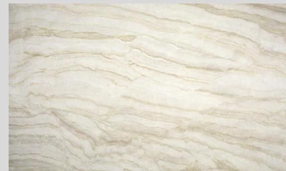
O quartzito Perla Venata apresenta um grau de absorção médio sendo necessário impermeabilizar todo o material (hidro óleo repelente na superfície e nos topos e argamassa polimérica impermeabilizante no verso, respeitando o tempo de cura dos produtos aplicados e aguardando secagem completa da argamassa para o rejuntamento). Suporta variação de temperatura e não apresenta problemas com produtos pouco ácidos e alcalinos.
