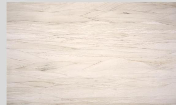
O quartzito arenoso Kalahari apresenta um grau de absorção um pouco maior do que os quartzitos comuns, sendo necessário impermeabilizar todo o material (hidro óleo repelente na superfície e nos topos e argamassa polimérica impermeabilizante no verso, respeitando o tempo de cura dos produtos aplicados e aguardando secagem completa da argamassa para o rejuntamento). Suporta variação de temperatura e não apresenta problemas com produtos pouco ácidos e alcalinos.
