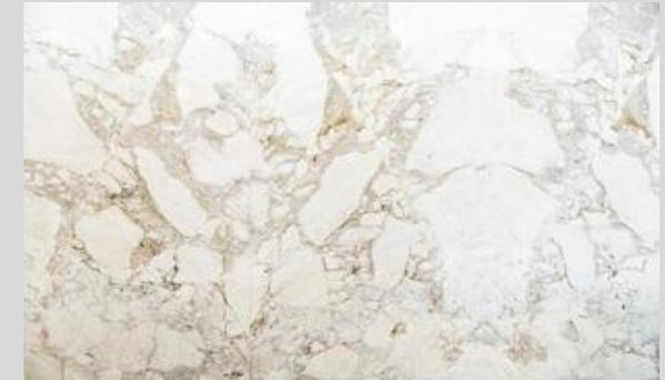
O mármore Nuvolato apresenta um grau de absorção considerável sendo necessário impermeabilizar todo o material (hidro óleo repelente na superfície e nos topos e argamassa polimérica impermeabilizante no verso, respeitando o tempo de cura dos produtos aplicados e aguardando secagem completa da argamassa para o rejuntamento). Ter cuidado com variação de temperatura e produtos ácidos e alcalinos.
