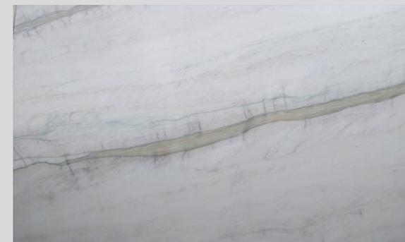
Os quartzitos arenosos Quebec (polido) e Montreal (escovado) apresentam um grau de absorção um pouco maior do que os quartzitos comuns, sendo necessário impermeabilizar todo o material (hidro óleo repelente na superfície e nos topos e argamassa polimérica impermeabilizante no verso, respeitando o tempo de cura dos produtos aplicados e aguardando secagem completa da argamassa para o rejuntamento). Suporta variação de temperatura e não apresenta problemas com produtos pouco ácidos e alcalinos.
