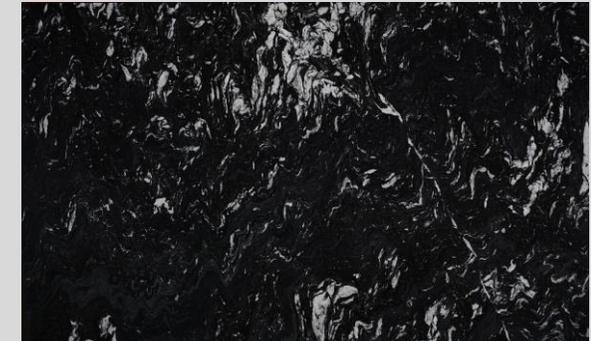
O mármore Mandala Black apresenta um grau de absorção considerável sendo necessário impermeabilizar todo o material (hidro óleo repelente na superfície e nos topos e argamassa polimérica impermeabilizante no verso, respeitando o tempo de cura dos produtos aplicados e aguardando secagem completa da argamassa para o rejuntamento). Ter cuidado com variação de temperatura e produtos ácidos e alcalinos.
