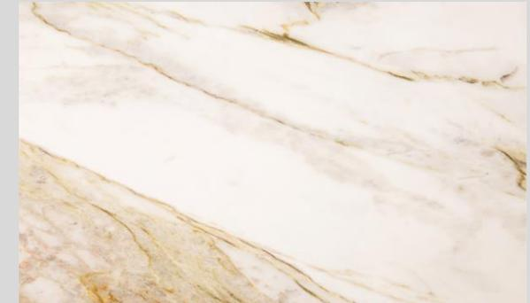
O mármore Calacatta Premium apresenta um grau de absorção considerável sendo necessário impermeabilizar todo o material com hidro óleo repelente na superfície e nos topos e argamassa polimérica impermeabilizante no verso, respeitando o tempo de cura dos produtos aplicados e aguardando secagem completa da argamassa para o rejuntamento. Ter cuidado com variação de temperatura e produtos ácidos e alcalinos.
