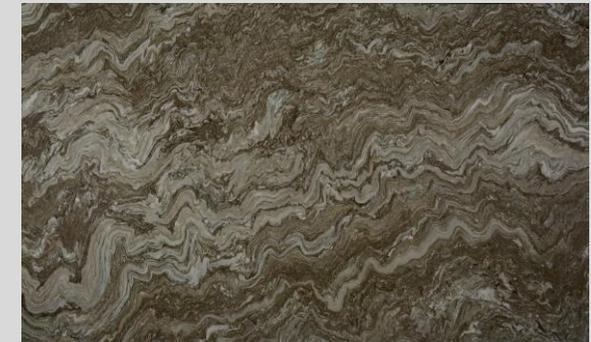
O mármore Mandala apresenta um grau de absorção considerável sendo necessário impermeabilizar todo o material (hidro óleo repelente na superfície e nos topos e argamassa polimérica impermeabilizante no verso, respeitando o tempo de cura dos produtos aplicados e aguardando secagem completa da argamassa para o rejuntamento). Ter cuidado com variação de temperatura e produtos ácidos e alcalinos.
