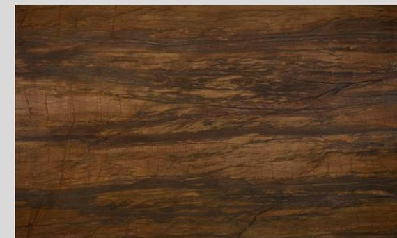
O quartzito natural Sandalus apresenta um grau de absorção médio sendo necessário impermeabilizar todo o material (hidro óleo repelente na superfície e nos topos e argamassa polimérica impermeabilizante no verso, respeitando o tempo de cura dos produtos aplicados e aguardando secagem completa da argamassa para o rejuntamento). Suporta variação de temperatura e não apresenta problemas com produtos pouco ácidos e alcalinos.
