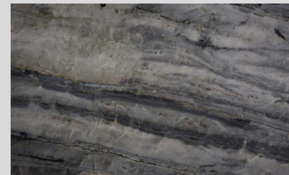
O quartzito Blue Moon apresenta um grau de absorção médio sendo necessário impermeabilizar todo o material (hidro óleo repelente na superfície e nos topos e argamassa polimérica impermeabilizante no verso, respeitando o tempo de cura dos produtos aplicados e aguardando secagem completa da argamassa para o rejuntamento). Suporta variação de temperatura e não apresenta problemas com produtos pouco ácidos e alcalinos.
