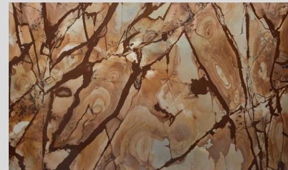
O quartzito Woodstone apresenta um grau de absorção médio sendo necessário impermeabilizar todo o material (hidro óleo repelente na superfície e nos topos e argamassa polimérica impermeabilizante no verso, respeitando o tempo de cura dos produtos aplicados e aguardando secagem completa da argamassa para o rejuntamento). Suporta variação de temperatura e não apresenta problemas com produtos pouco ácidos e alcalinos.
