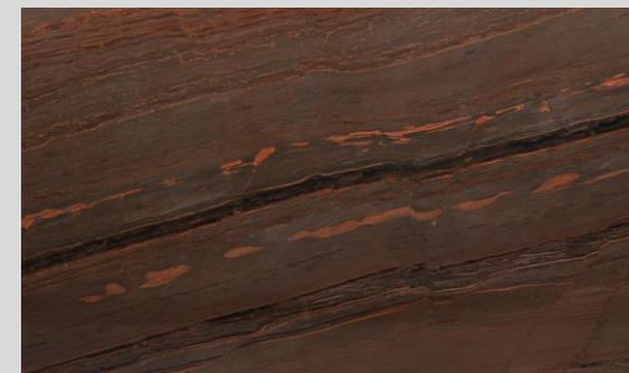
O quartzito arenoso Fantastic Brown apresenta um grau de absorção um pouco maior do que os quartzitos comuns, sendo necessário impermeabilizar todo o material (hidro óleo repelente na superfície e nos topos e argamassa polimérica impermeabilizante no verso, respeitando o tempo de cura dos produtos aplicados e aguardando secagem completa da argamassa para o rejuntamento). Suporta variação de temperatura e não apresenta problemas com produtos pouco ácidos e alcalinos.
