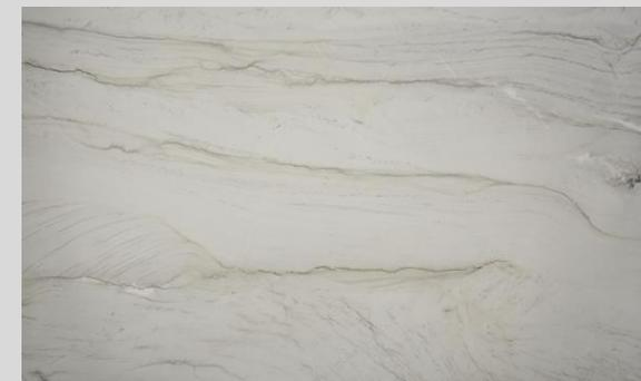
O quartzito Mont Blanc apresenta um grau de absorção médio sendo necessário impermeabilizar todo o material (hidro óleo repelente na superfície e nos topos e argamassa polimérica impermeabilizante no verso, respeitando o tempo de cura dos produtos aplicados e aguardando secagem completa da argamassa para o rejuntamento). Suporta variação de temperatura e não apresenta problemas com produtos pouco ácidos e alcalinos.
