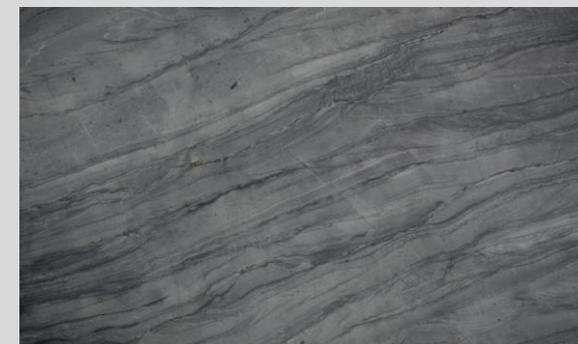
O quartzito natural Platinus apresenta um grau de absorção médio sendo necessário impermeabilizar todo o material (hidro óleo repelente na superfície e nos topos e argamassa polimérica impermeabilizante no verso, respeitando o tempo de cura dos produtos aplicados e aguardando secagem completa da argamassa para o rejuntamento). Suporta variação de temperatura e não apresenta problemas com produtos pouco ácidos e alcalinos.
